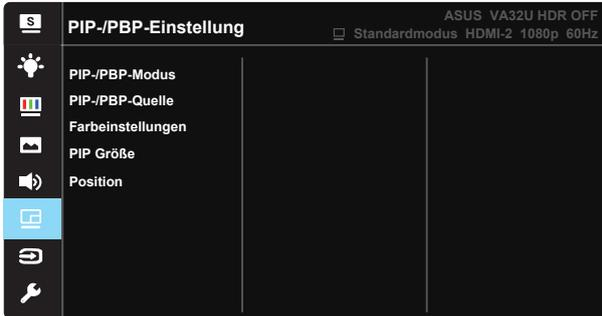
Durch Aktivierung dieser Funktion zeigt der Monitor zwei Bilder von einer oder zwei Videoquellen an.
